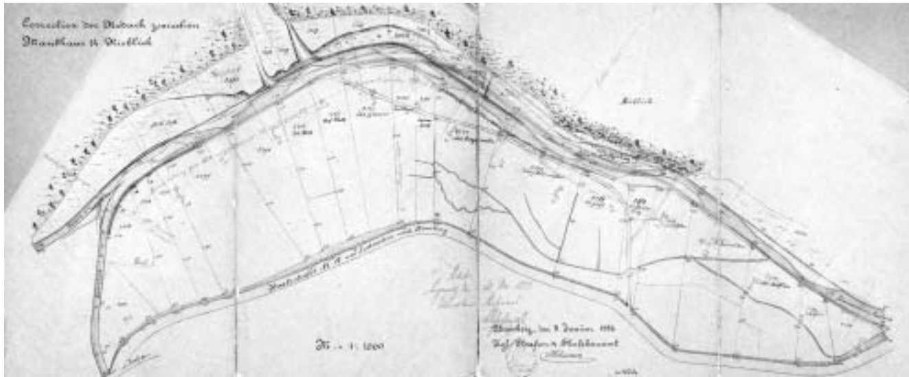
Die Flussläufe wurden für eine leichtere Floßfahrt begradigt und ihre Kiesbänke entfernt. Hier eine „Correction“ an der Rodach bei Mauthaus vom Ende des 19. Jahrhunderts.
