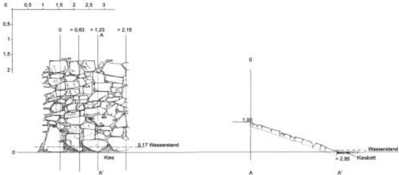
Uferpflasterung aus Bruchsteinen an einem Gleitufer der Langenau Element L 10 Up 20. - 21.09.2003
